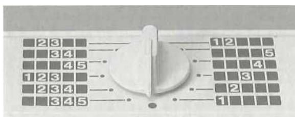
Мотив Магия делится на 5 разделов на иглу кровати, каждая секция в составе 24 игл. В разделе номера напечатанный на фильм лежал под игрой защелки. Когда он установлен на передней • марки, никаких
