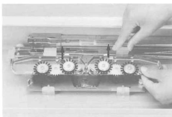
Отсоедините два рычага блокировки и удаления ткани с прижимной крышке корпуса.
