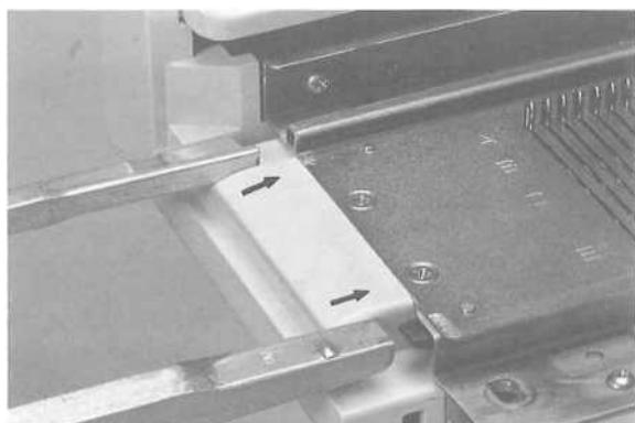
Снять оба расширение рельсов из крышки корпуса.
