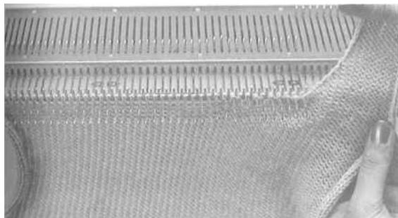
Установить рычаг частичного вязать до 0. С отходы пряжи вязать 10 рядов по иглам в Е положение и удалите вязания из машины.
