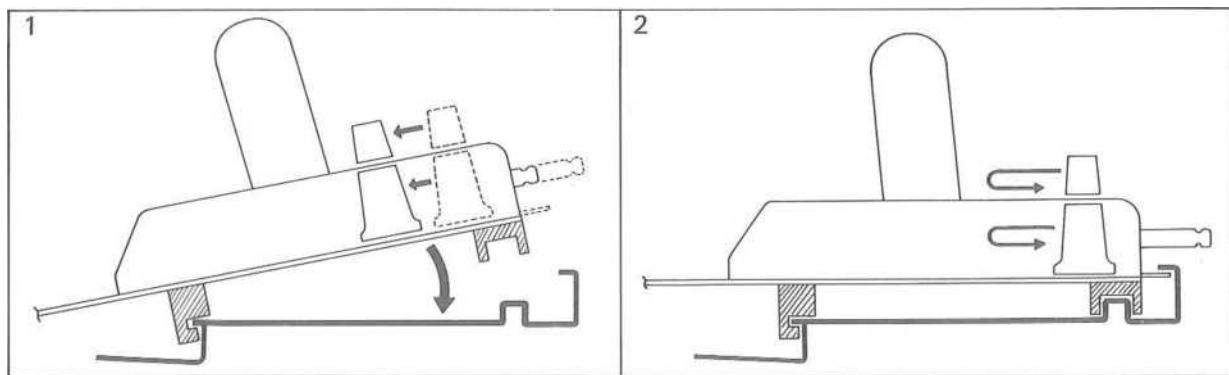
Чтобы переместить основные каретки на и от иглы постели вы должны удалить ткань лапки. Это не является необходимым при установке или удалении каретки на расширение рельсов. Опустите переднюю часть вагона на передней направляющей, направляющая каретки должны вписываться в передней направляющей, 1.
