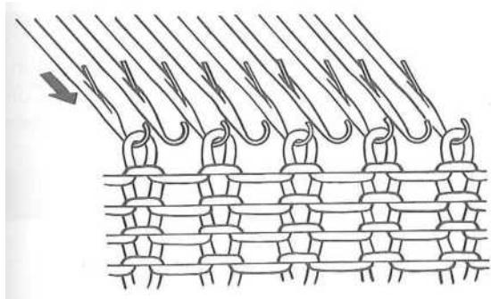
С линейкой селектора расческу принести в промежутках между иглами от А до Б позиции. Удалить бросок на расческу с вязанием.
