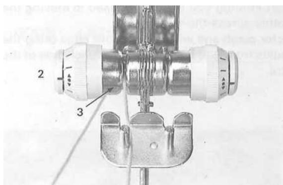
Возьмите нить верхнего блока напряженность и в передней части заднего контакта 2.
