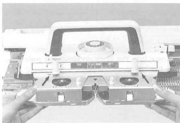
Ослабьте винты и сдвиньте прижимной ткани на каретку, тянуть прижимной немного вперед так, чтобы и вырезы подходят вокруг винтами и двумя колышками каретки (стрелки) в отверстия ткани лапки.
