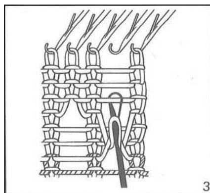
Поймать следующего бара. Опустите инструмент, и пусть бар протягивают через петлю и сдвиньте его опережать защелку. Это
