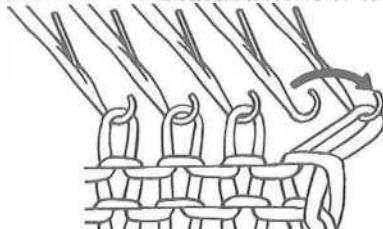
При передаче инструмента, передавать в конце стежка на соседнюю пустую иглу.
