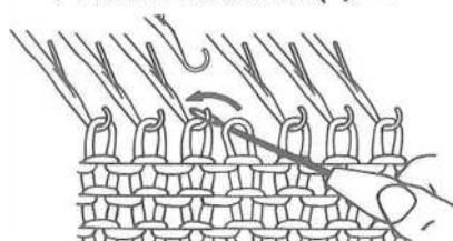
Поднимите передачи инструмента из крючок. Переместить его на левый и поместить в ушко иглы крюк соседней иглы. Наклон вверх инструмент, строчка будет скользить его и на крючок.
