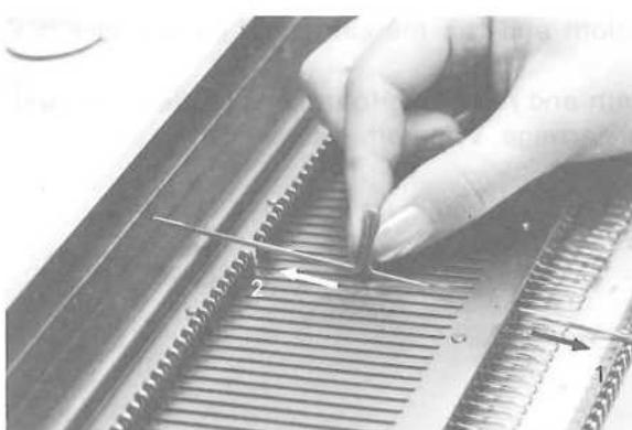
Возьмите запасные иглы и открыть защелку иглу, сдвиньте иглу внутрь канавки в направлении спереди в положение E, 1.
