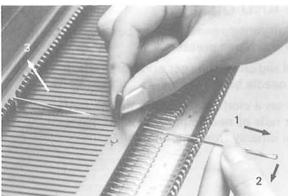
Держа иглу прикладом сдвиньте его в положение E, 1, надавите на крюк 2 так, чтобы игла хвостовик выходит из иглы постели на спине и на панели правления машины.
