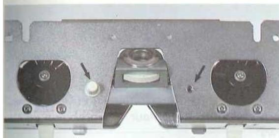
Настройте отверстия для большого пальца винтом как единица и ткани прижимной (стрелки).
