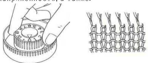
Когда напряжение режимов установлен в 10, стежки будут **LOOSE** (большой).
