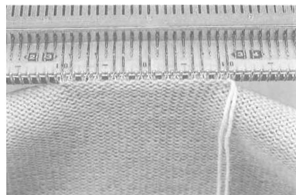
Работа кусок одежды до размещения линии для кармана. Каретки справа, все настройки нейтральной. Удалить цв. 1 и крюк в держатель.
