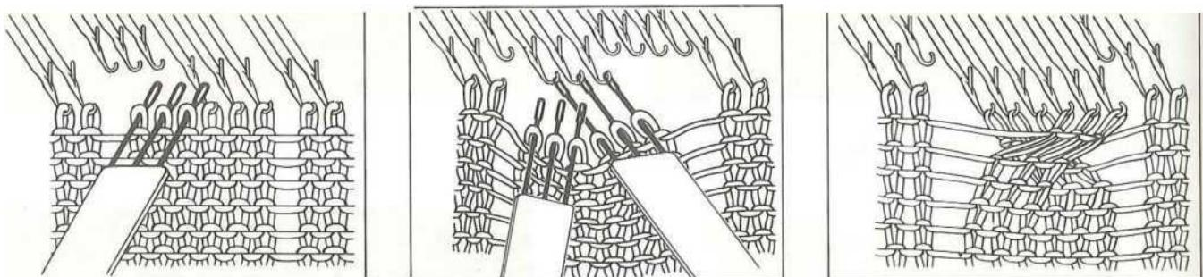
На каждой справа и слева от центра передаче 4-го стежка на соседние пятью иглой. Принесите пустые иглы положение. Вязать ок. 10 строк. Крючок тройной инструмент передачи в 3 иглы слева от центра, вытащить их на E, то подтолкнуть их обратно на позиции. Стежки на передачу инструмент. Поднимите стежки из иглы.
