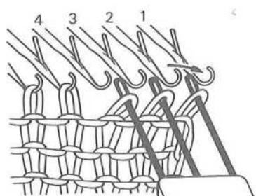
3 стежка в настоящее время на стеблях инструмент. Медленно поднимите инструмент из иглы крючки, в то же время вы откроете иглы защелки.
