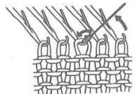
Вытащите иглу в положение **B**, наклонить инструмент и дайте строчку слайд в крючок.
