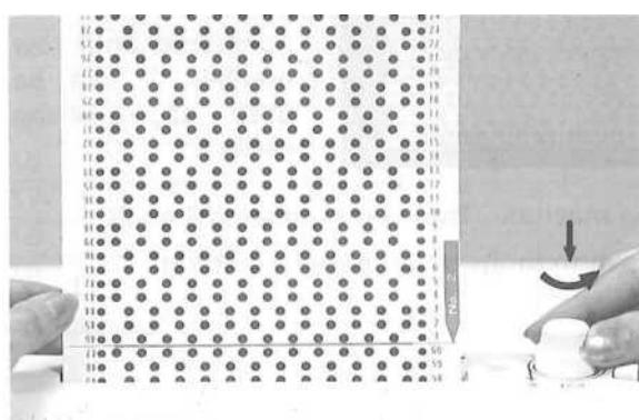
Нажмите подачи циферблатором и в то же время превратить его в течение 2 или 3 положения, чтобы заблокировать карту в направлении против часовой
