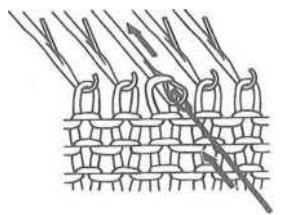
Возьмите один инструмент передачи, подключить его в иглу и вытащить иглу вперед к **E** положение;
