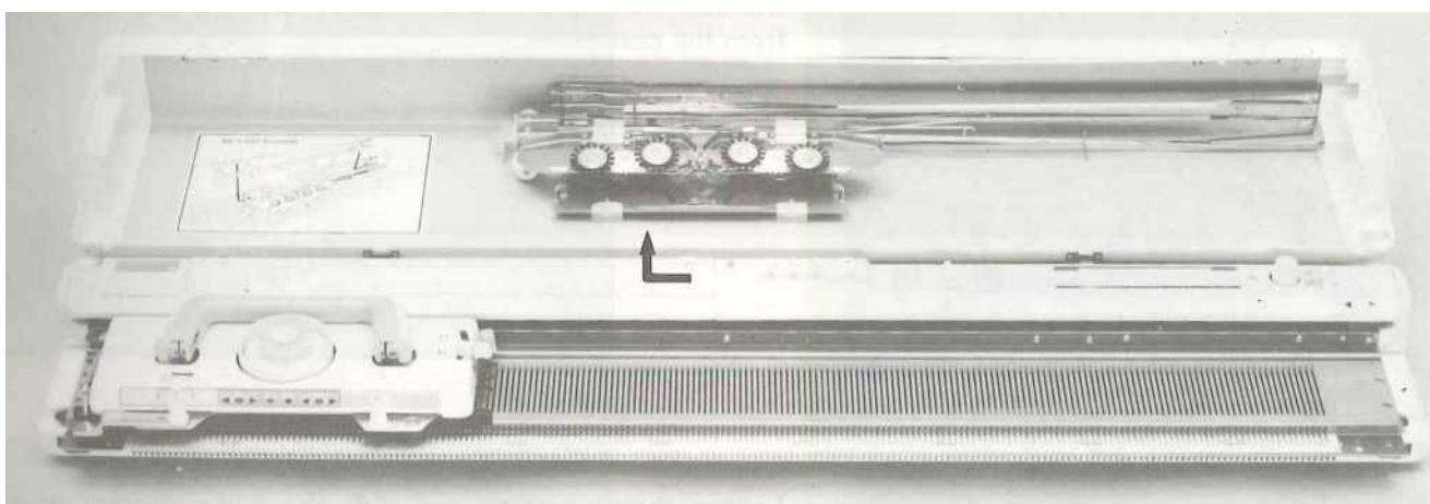
на рычаг фиксатора в направлении левого и снимите крышку вспомогательного случае (стрелка)
